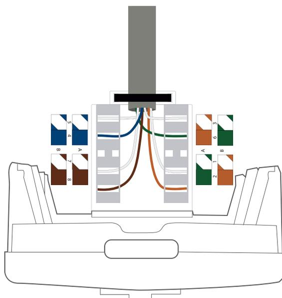
Exemplo de conexão NORMA T568B
